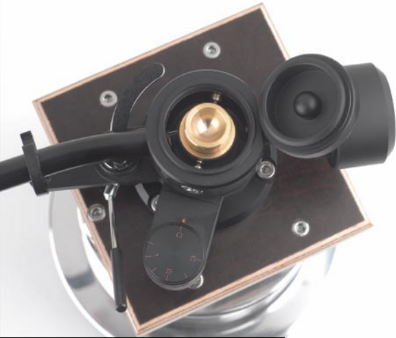
Die Ölwanne der Dämpfungseinrichtung sitzt fest auf dem Armschaft, dort taucht ein „Paddel“ unter dem Schraubdeckel ein
